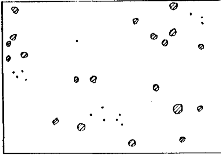
Şekil 13 Kalite seviyesi 4'e göre belirtiler Yirmi belirtide en büyük boyut 5 ve 14 mm arasındadır
