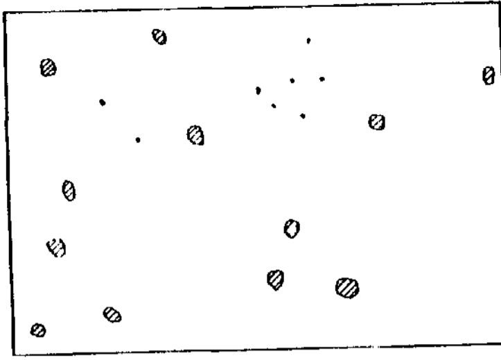
Şekil 12 Kalite seviyesi 3'e göre belirtiler Oniki belirtide en büyük boyut 3 ve 9 mm arasındadır
