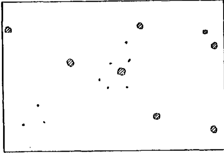
Şekil 11 Kalite seviyesi 2'ye göre belirtiler Sekiz belirtide en büyük boyut 2 ve 6 mm arasındadır
