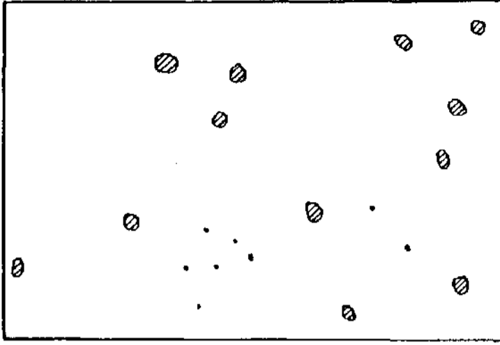
Şekil 12. Kalite seviyesi 3'e göre belirtiler. 12 belirtide en büyük boyut 3 ve 9 mm arasındadır.
